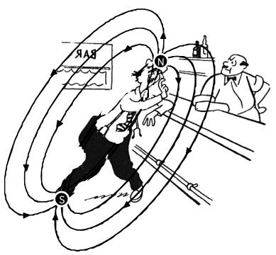
MAGNETIC FIELD LINES AROUND A BAR MAGNET
